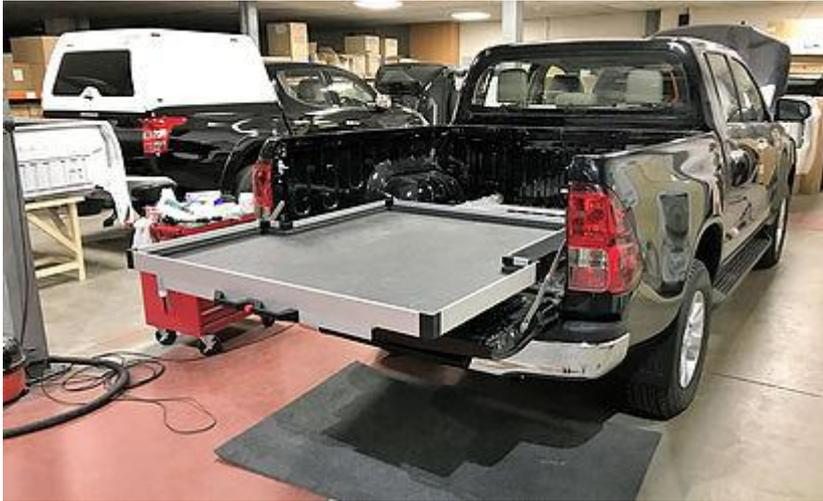
Il cassetto lineare è particolarmente utile nelle versioni custom per i piani di carico dei pick up, garantendo un aiuto al carico e scarico di merce, grazie ad un robusto ripiano estraibile, resistente alla corrosione e ai carichi elevati, completamente lavabile e duraturo. Il nostro prodotto è testato per resistere a 500kg di carico quando è chiuso e fino a 250kg quando è esteso (massima estensione 70% della sua Lunghezza)
